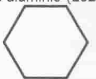
Bulón de material de baja resistencia
