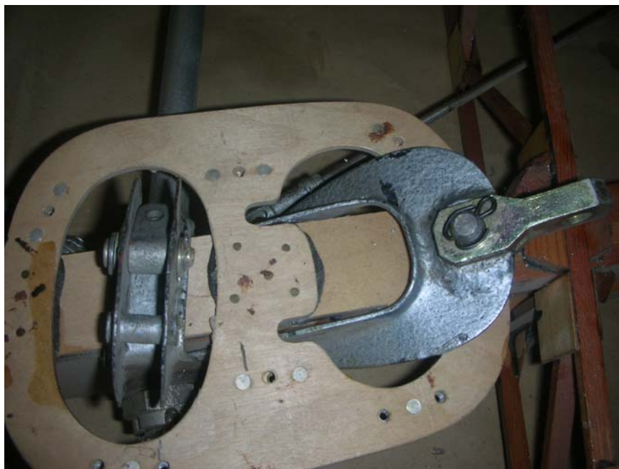
Réalisation amateur d'une aile, le positionnement de l'ancrage est incorrect.
