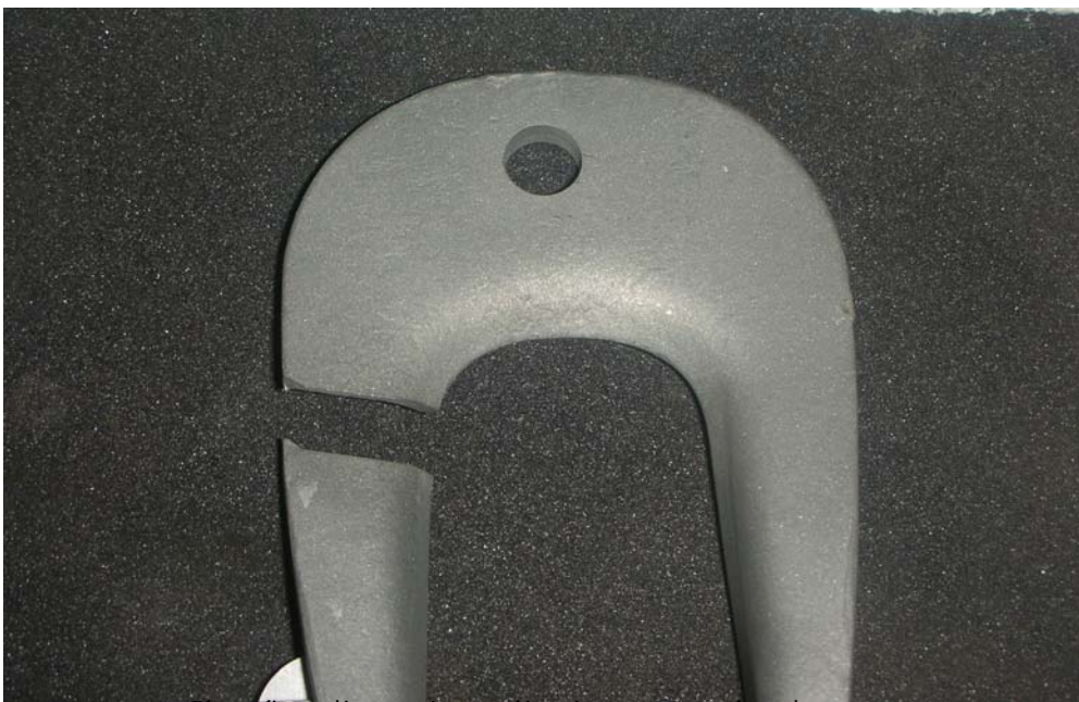
Photo d'une pièce cassée, non détectée par manque de maintenance.
