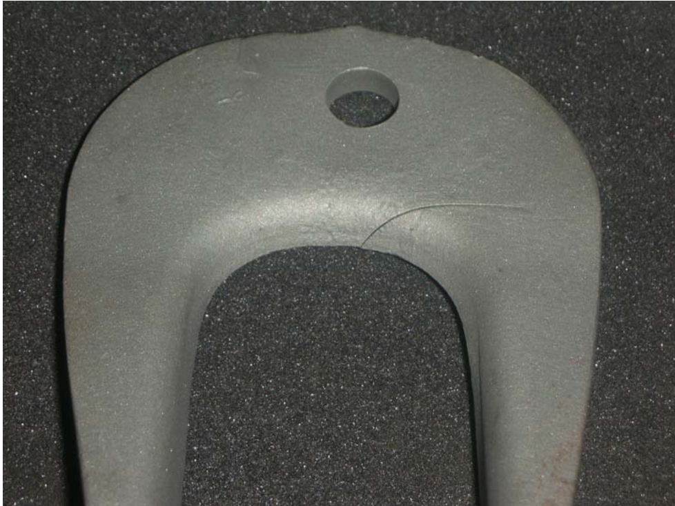
Photo d'une pièce fendue, mal positionnée, et détectée lors d'une opération de maintenance périodique.
